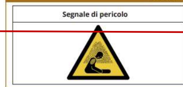
Figura 2 Segnale di pericolo W041 "Atmosfera asfissiante"
