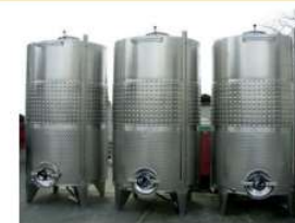
Figura 5 Autoclave per la vinificazione a freddo
